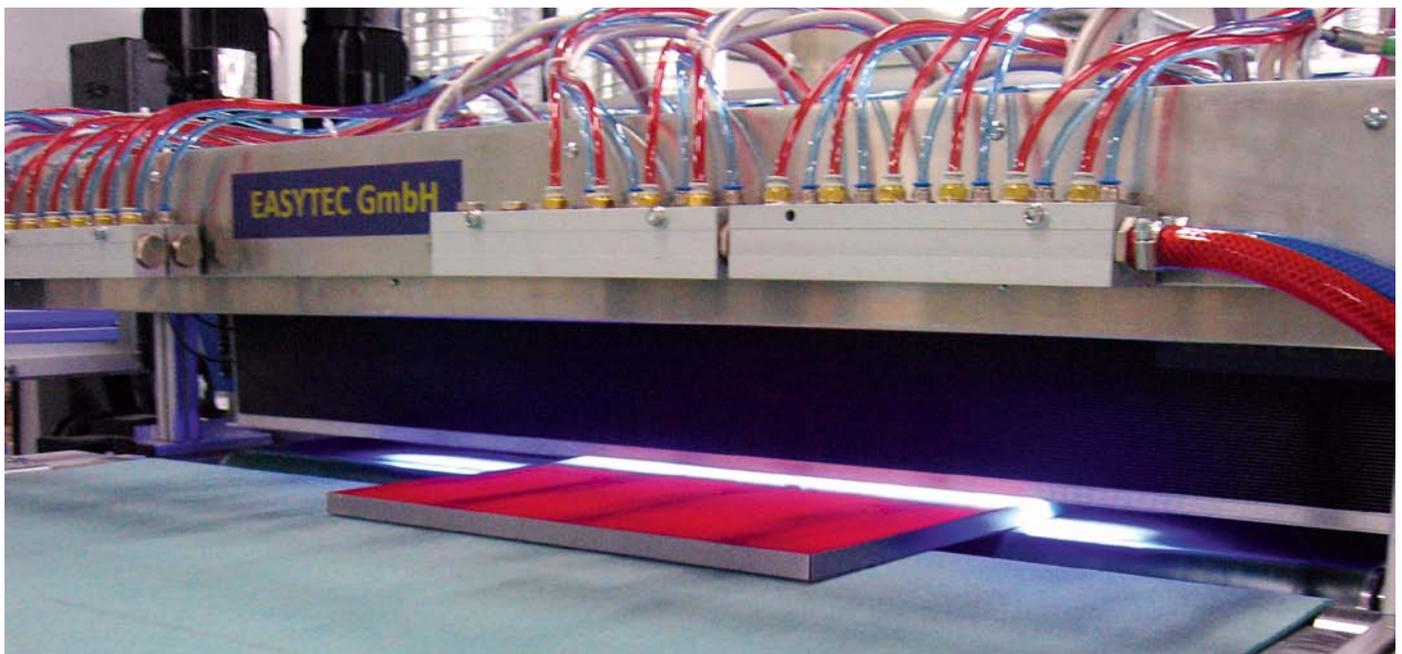
UV-LED-Lampen reduzieren den Energieeinsatz und besitzen eine deutlich längere Lebensdauer als herkömmliche UV-Strahler.
