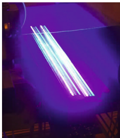
Die UV-LED-Technologie ermöglicht einfaches Beschichten und Aushärten von wärmesensiblen Kunststoffteilen (Foto: Easytec)
